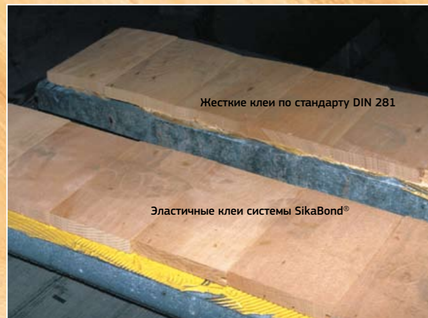
Рис. 5. Испытания при воздействии экстремальных нагрузок: массивная доска из бука толщиной 21 мм, влажность древесины 22%
